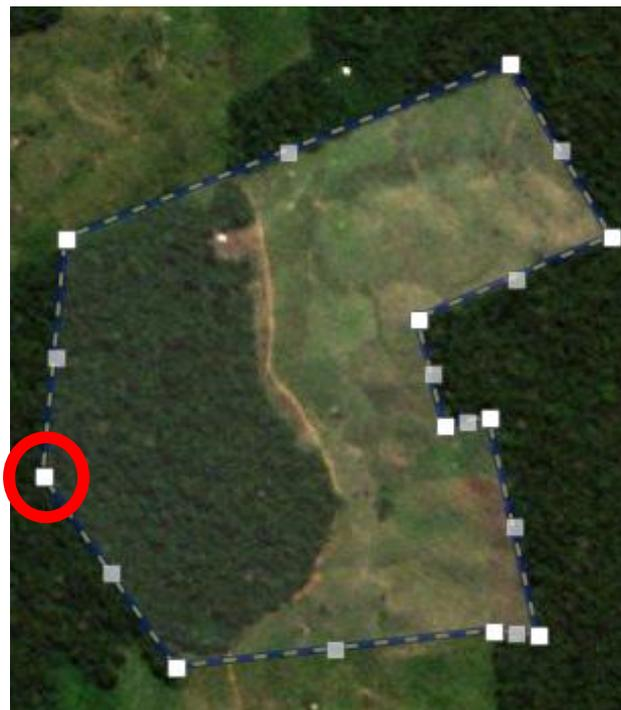
Figura 4.48 – Ao clicamos no ponto cinza mais à esquerda e o arrastarmos, um novo vértice é criado (em destaque).
