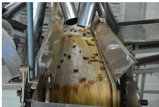
Figura 13: Processo de seleção mecanizada de castanhas-do-brasil nas dependências da Cooperacre.
